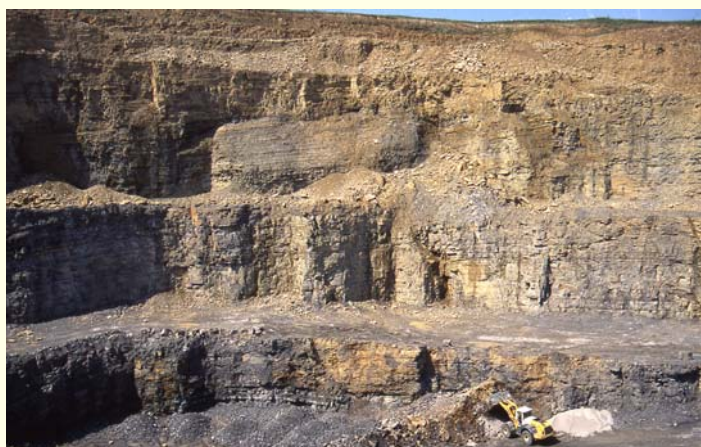
Abb. 3: Gewinnung von Karbonatgesteinen des Oberen Muschelkalks im Steinbruch Mauer (RG 6618-1) für Straßenbaumaterial.
