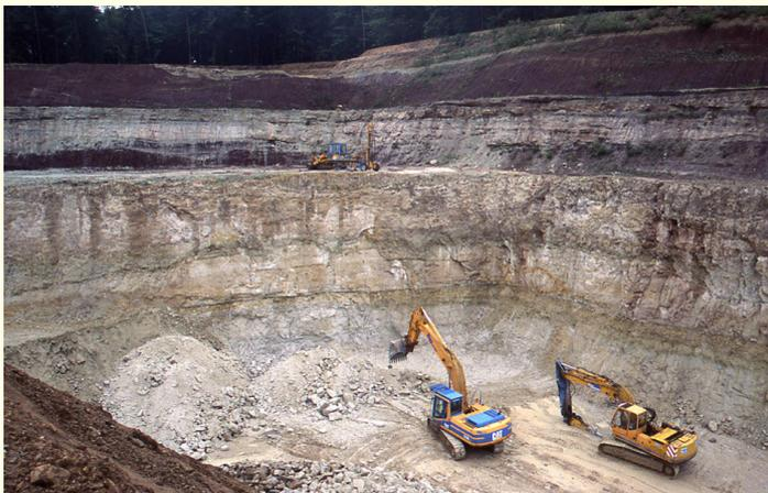
Abb. 3: Gewinnung von Mürbsanden aus der Stubensandstein-Formation (km4) im Steinbruch Kernen-Stetten im Remstal (RG 7221-4).
