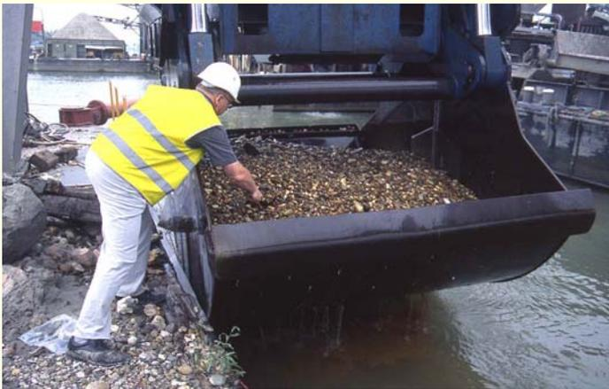
Abb. 1: Beprobung von Rohkies aus dem Greifer eines Schwimmbaggers, Kappel-Grafenhausen.
