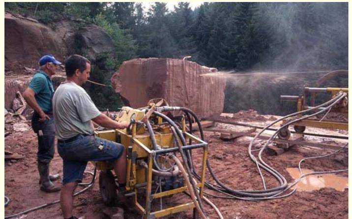
Abb. 6: Gewinnung von Buntsandsteinrohblöcken mittels Seilsäge, Steinbruch im Bleichbachtal bei Kenzingen
