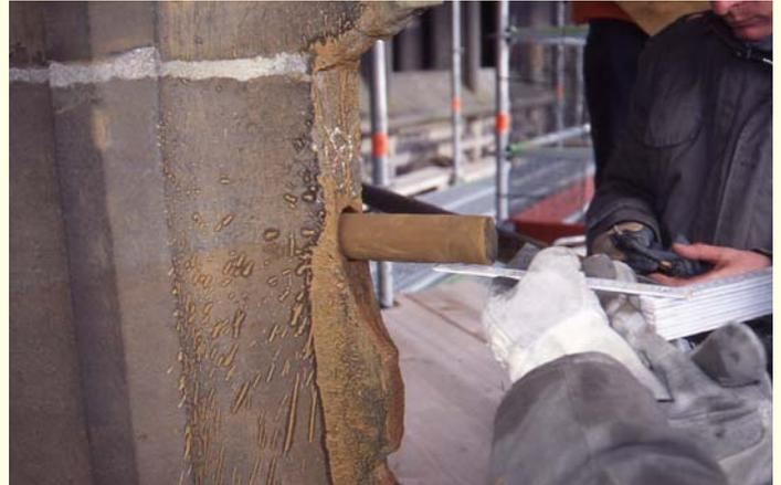
Abb. 2: Entnahme von Bohrkernen am Hauptturm des Ulmer Münsters zur petrographischen und gesteinsphysikalischen Untersuchung.
