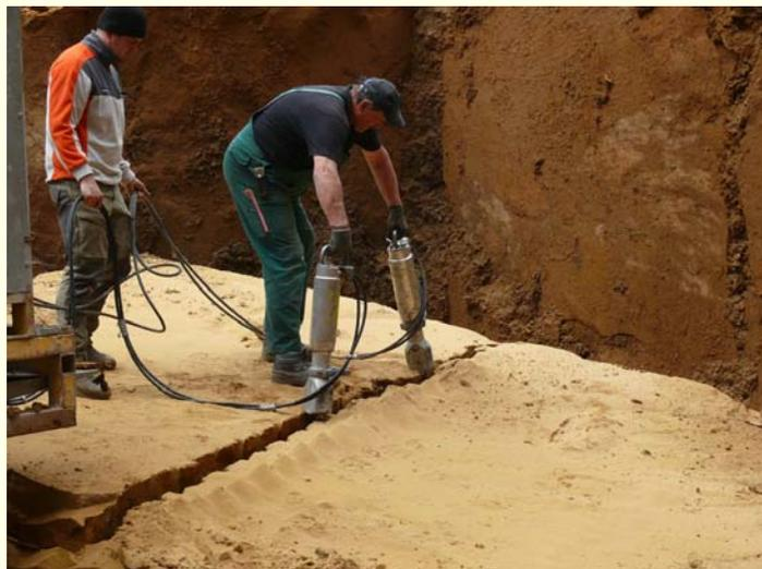
Abb. 5: Spalten eines großen Rohblocks im Steinbruch vor dem Abtransport ins Natursteinwerk zur weiteren Bearbeitung und Untersuchung.
