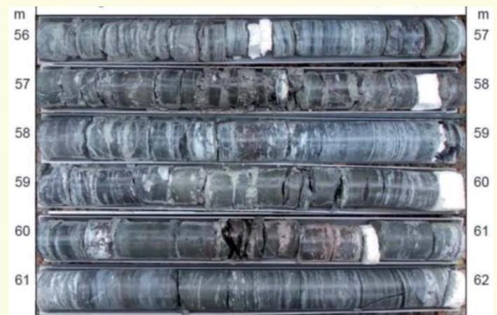
Abb. 4: Bohrkernfoto der Gesteine aus der Mittleren Grabfeld-Formation (Erkundungsbohrung B1a).
