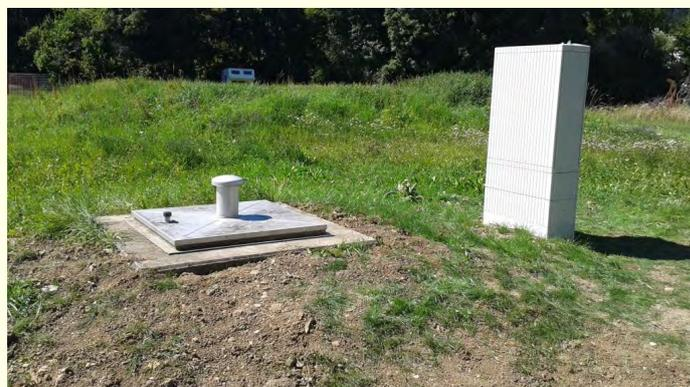
**Abb. 3:** Starkbebenmessstation in Jungingen (Zollernalbkreis): der Elektronikschaltkasten steht oberirdisch (rechts), während das Seismometer im Schacht unter dem Deckel (links) eingebaut wurde.
