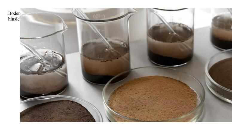
Z.?B. werden für Musterprofile oder auch als kartierbegleitende Analytik die Korngrößenverteilung, die Porosität, der Kalkgehalt, der pH-Wert, der Kohlenstoff- und Stickstoffgehalt und andere Parameter an gestörten und ungestörten Bodenproben ermittelt.
