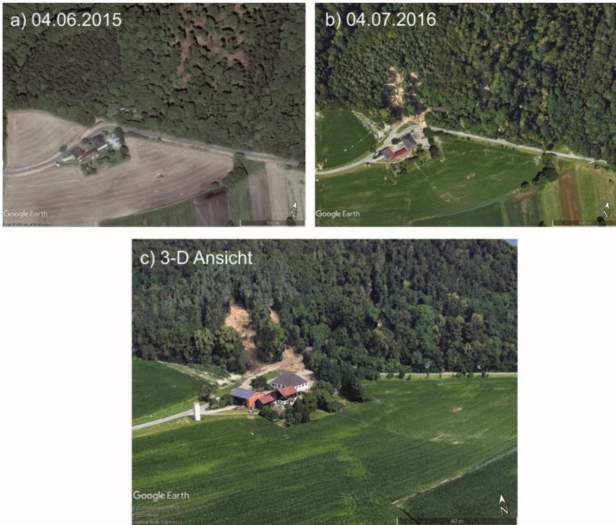
Abb. 2-54: Luftbildaufnahmen im Zusammenhang mit dem Starkregenereignis vom 01.06.2016 westlich der Ortschaft Simbach: a) Situation ein Jahr vor dem Starkregenereignis; b) ein Monat nach dem Starkregenereignis; c) 3D-Ansicht des Hanges mit einem Hanganbruch ein Monat nach dem Starkregenereignis (Quelle: Google Earth, Tag des Zugriffs: 04.05.2020). (s. [Deckblatt](#), [linkes Foto](#)).
