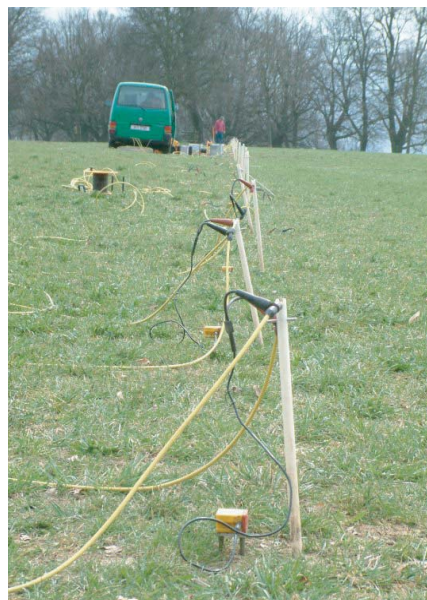
Abb. 1: Beispiel für eine Auslage von Geophonen über mehrere 100 Meter
