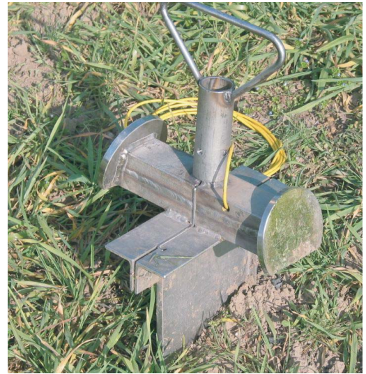
Abb. 2: Der „Spaten“ zur Anregung von Scherwellen mit dem Vorschlaghammer
