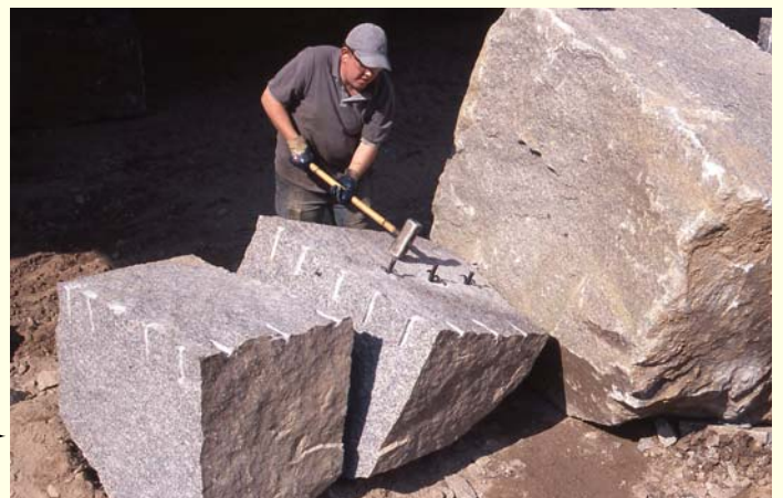
Abb. 2: Spalten von Werksteinblöcken aus Forbach-Granit (Raumünzachgranit) im Steinbruch Forbach-Raumünzach (Murgschifferschaftsbruch, RG 7316-3).
