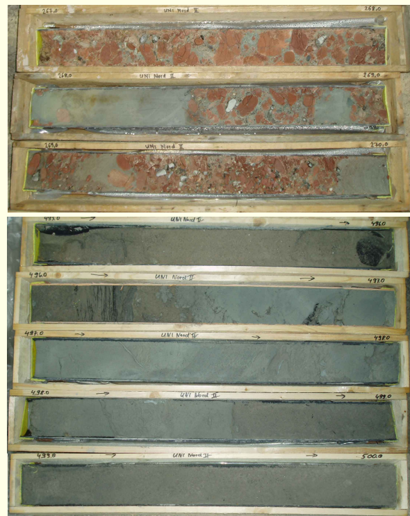
Abb. 2: Bohrkern aus der Forschungsbohrung Heidelberg: oben: Schutt des Odenwalds (roter Sandstein) und feinkörnige Seesedimente (grünlich grau) der Eburon-Kaltzeit (267 – 270 m Teufe) unten: Flusssande (grau) und Feinsedimente (grünlich grau) der Tegelen-Warmzeit (495 – 500 m Teufe), bei 496 m ein inkohltes Holzgeröll
