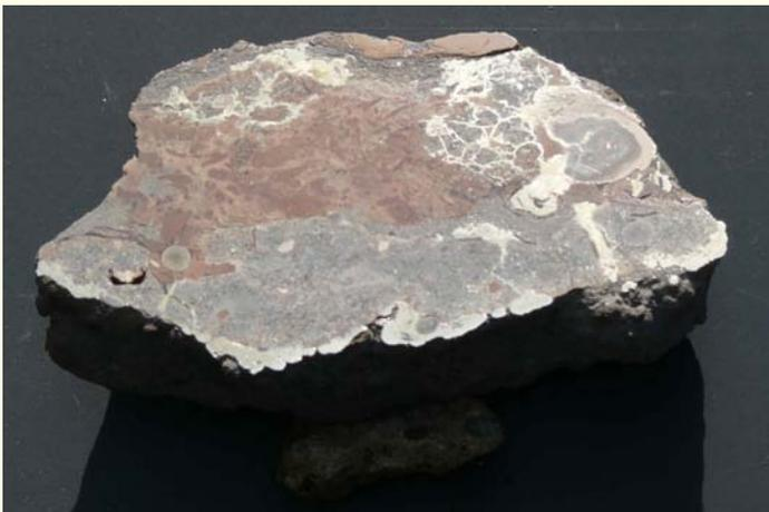
Abb. 1: Anschliff eines Handstücks aus der Comptumbank im Mitteljura; die hell glänzende Vererzung besteht weitgehend aus Pyrit und beinhaltet neben Eisen und Schwefel noch weitere Schwermetalle.
