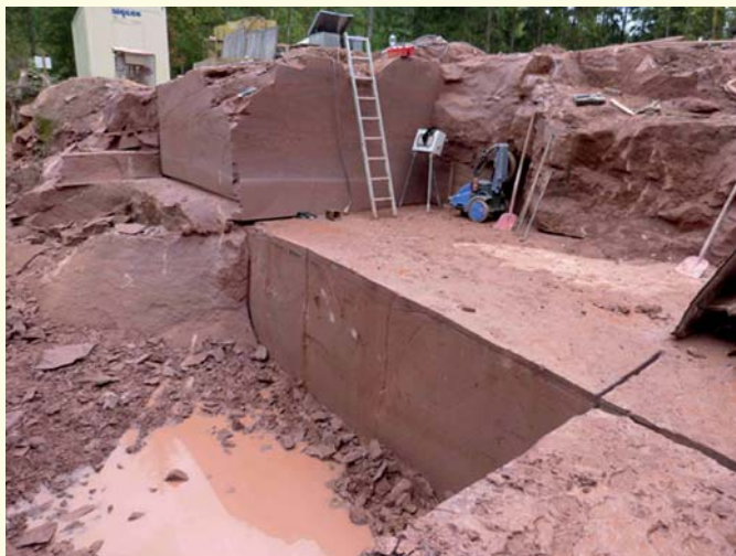
Abb. 1: Abbau von Buntsandstein im neuen „Münstersteinbruch“ bei Tennenbach (Kreis Emmendingen); mit der Schwertsäge erstellter Aufschluss unterhalb der historischen Abbausohle (Foto: W. Werner).
