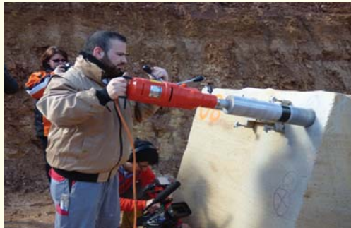
Entnahme von Bohrkernen aus einem frisch gewonnenen Rohblock zur gesteinsphysikalischen Untersuchung.
