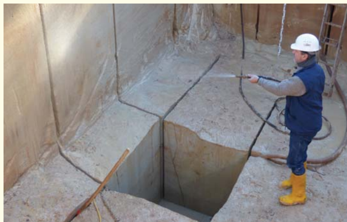
Kompaktes, ungeklüftetes Lager im Oberen Stubensandstein, beim Probeabbau freigelegt mit der 2,3 m langen Schwertsäge.
