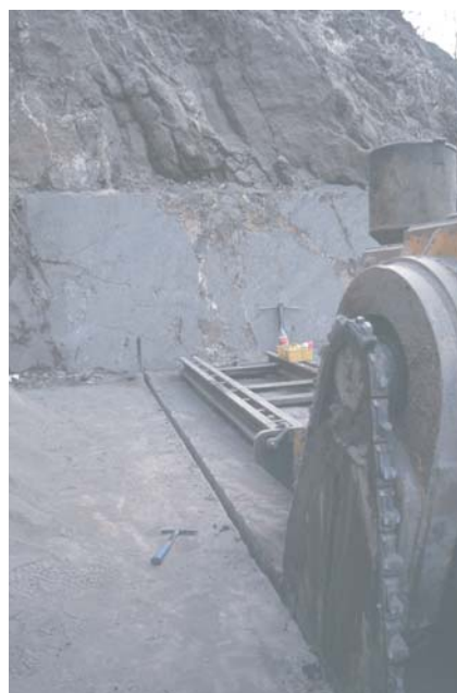
Bild 2: Schrämsäge im Steinbruch am Achkarrener Schlossberg
