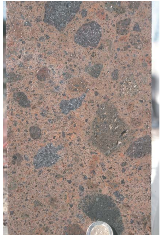
Bild 4: Tephrit-Pyroklastit, der "Kaiserstühler Tuffstein", ein aus vulkanischem Ascheregen entstandenes Gestein mit großen Auswürflingen
