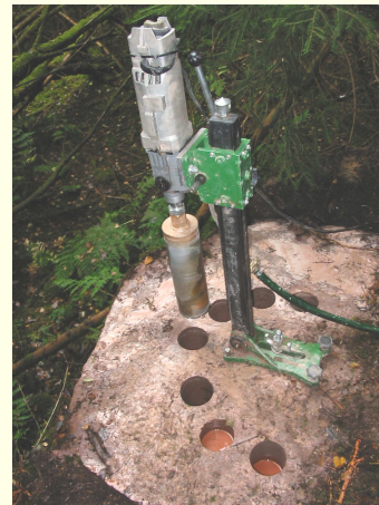
Abb. 1: Entnahme von Bohrkernen in Gelände zur Gesteinsprüfung (links) und Durchführung von felsmechanischen Untersuchungen im petro-physikalischen Labor des Geologischen Instituts der Universität Freiburg (rechts)
