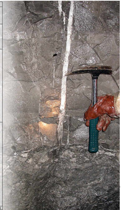
Abb. 4: Übergang Obere Dolomitformation / Obere Sulfatschichten des Mittleren Muschelkalks mit senkrechter Gipskluft - Teufsohle 156,80 m
