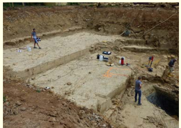
Abb. 3: Links: Burg Hohenzollern bei Hechingen, erbaut überwiegend aus Angulatensandstein, der in zahlreichen kleinen Steinbrüchen im nördlichen Vorland der Burg gewonnen wurde. Rechts: Gewinnung von Angulatensandstein im Probeabbau bei Grosselfingen im Juni 2018.
