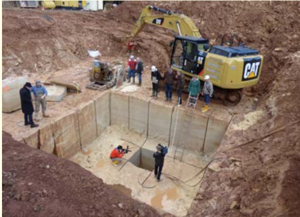
Abb. 2: Links: Probeabbau im Stubensandstein von Waldenbuch im Frühjahr 2015. Nach mehrjährigen Erkundungsarbeiten im ausgedehnten Waldgebiet des Naturparks Schönbuch wurde durch einen Neuaufschluss eine kompakte Sandsteinbank von 5–6 m Mächtigkeit nachgewiesen. Rechts: Aus Waldenbucher Stubensandstein erstelltes Maßwerk im Werkhof der Ulmer Münsterbauhütte.
