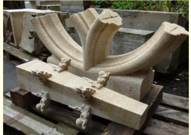
Abb. 2: Links: Probeabbau im Stubensandstein von Waldenbuch im Frühjahr 2015. Nach mehrjährigen Erkundungsarbeiten im ausgedehnten Waldgebiet des Naturparks Schönbuch wurde durch einen Neuaufschluss eine kompakte Sandsteinbank von 5–6 m Mächtigkeit nachgewiesen. Rechts: Aus Waldenbucher Stubensandstein erstelltes Maßwerk im Werkhof der Ulmer Münsterbauhütte.
