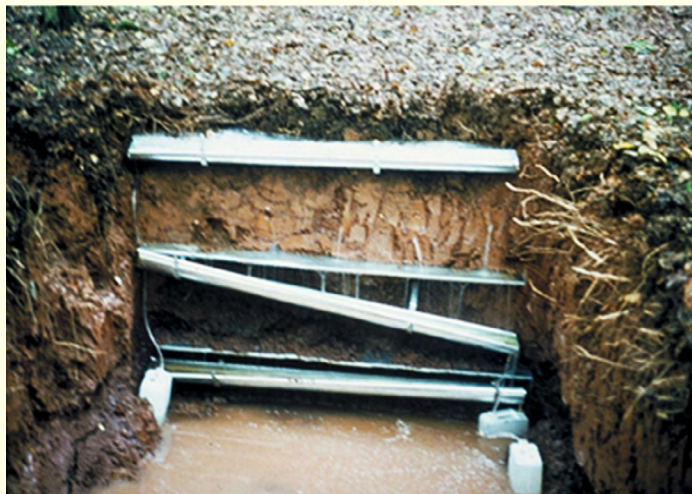
Abb. 2: Zwischenabfluss in präferenziellen Fließwegen – Beregnungsversuch auf Tonböden am Hang unter Wald (Schönbuch bei Herrenberg) .
