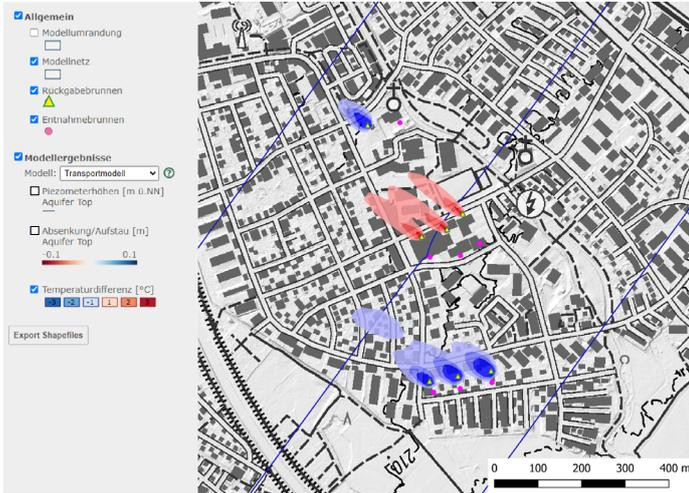
Abb. 3: Darstellung der Ergebnisse der thermohydraulischen Modellierung auf der aktuellen Web-Oberfläche von TOM.
